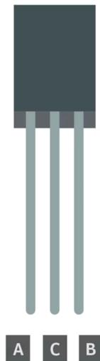
**A) Power B) Masse C) Ausgang** Das Programmieren des Sensors zur Messung und Ausgabe der Temperatur wird später im Abschnitt Sketch behandelt.
