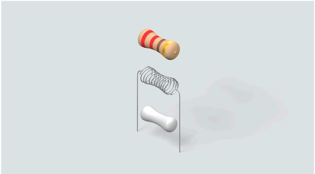
Widerstände haben normalerweise zwei Anschlussdrähte, einen an jedem Ende. Strom kann in beiden Richtungen durch einen Widerstand fließen, weshalb sie in einem Stromkreis in beiden Richtungen eingebaut werden können.
