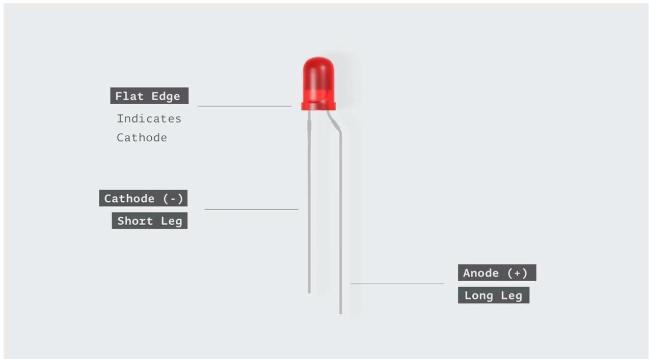
**7)** Führt die Anode (langer Draht) der LED in Klemme 1e des Steckbretts ein. Dadurch wird die gelbe LED an den 560 $\Omega$ -Widerstand angeschlossen. Denkt daran, dass die Anschlüsse 1a und 1e unter dem Steckbrett verbunden sind.
