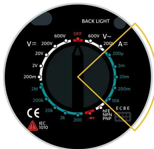
Für die Messung von Stromstärken bis 200 Milliampere muss das rote Prüfkabel in der Volt-Ohm-Milliampere-Buchse stecken (VΩmA). Der Wahlschalter wird dann auf einen der Milliampere-Messbereiche eingestellt. Für Stromstärke-Messungen bis zu 10 Ampere, muss das rote Prüfkabel in die 10ADC-Buchse gesteckt und der Drehschalter auf 10A gestellt werden. Diese Einstellung wird in unserem Kurs aber nicht benötigt.
