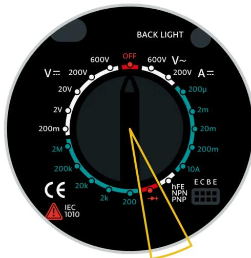
Die letzte Gruppe von Messbereichen ist für Widerstandsmessungen. Widerstandsgrößen sind durch den griechischen Buchstaben Omega ( $\Omega$ ) gekennzeichnet. Multimeter haben gewöhnlich mehrere Einstellungen für Widerstands-Messungen. Euer Multimeter hat fünf Messbereiche: 200 (200 Ohm), 2k (2 Kiloohm), 20k (20 Kiloohm), 200k (200 Kiloohm), and 2M (2 Megaohm). Diese Zahlen geben die Maximalwerte für jeden Messbereich an. Benutzt
