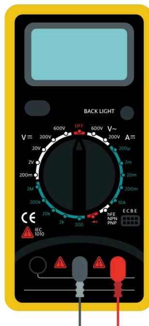
Mit dem Drehschalter am Multimeter teilt man die zu messende elektrische Größe und den Messbereich ein. Grundsätzlich versucht man den Messbereich so einzustellen, dass man die größte Genauigkeit erhält ohne den Höchstwert zu überschreiten.
