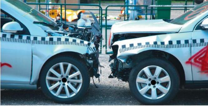
Bei Crashtests wird die Auswirkung eines Aufpralls auf das Fahrzeug und die Insassen bei verschiedenen Geschwindigkeiten experimentell untersucht. Schon ein Frontalaufprall mit nur 30 km/h kann fatale Auswirkungen haben. Sicherheitseinrichtungen im Fahrzeug sollen die Schäden mildern.
