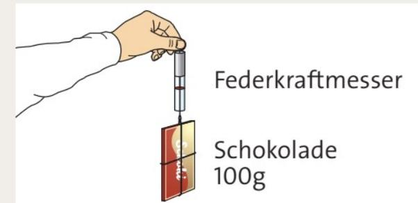
**Masse** Wird eine Tafel Schokolade auf eine Waage gelegt, zeigt das Messgerät die Masse an. Egal wo die Messung durchgeführt wird, die Masse beträgt überall 100 g bzw. 0,1 kg.
