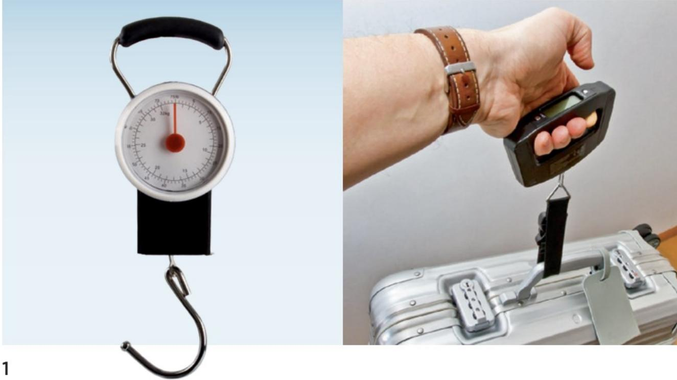
Überschreitet das Fluggepäck beim Einchecken die zulässige Masse, kann das teuer werden. Kofferwaagen bestimmen, mit welcher Kraft ein Koffer an der Aufhängung zieht. Ein Blick auf die Skala zeigt einen Messbereich von 32 kg an.
