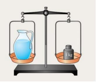
Waagen Eines der ältesten Messgeräte überhaupt ist die Balkenwaage. Mit ihr konnten die Händler die Massen ihrer Waren miteinander vergleichen. Will man jedoch die Massen von Körpern damit bestimmen, wird ein Wägesatz benötigt. ▶6,8
