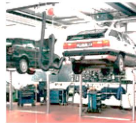
Hebebühnen sind hydraulische Anlagen.
