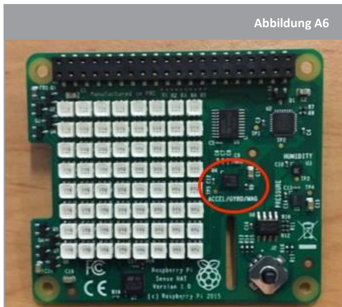
↑ IMU-Sensor im Sense HAT
